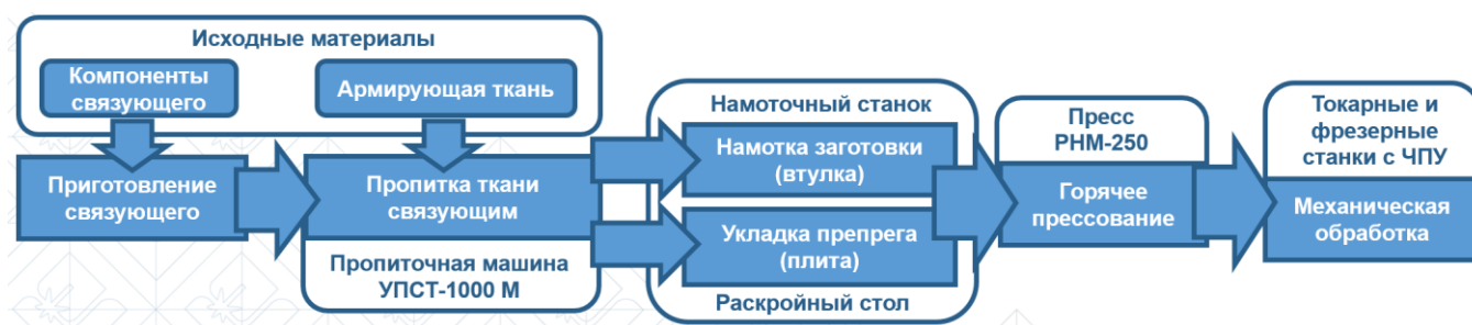
Рисунок 5.1 Принципиальная схема технологического процесса изготовления армированных антифрикционных ПКМ.
