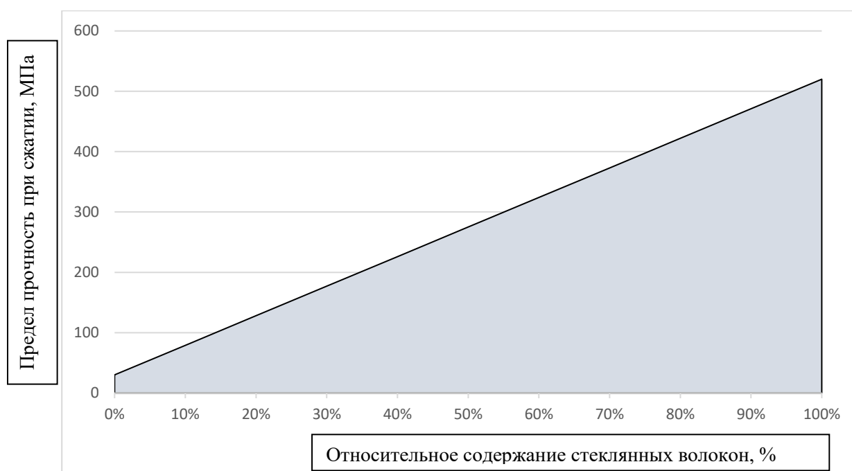
Рисунок 2.7 – Диаграмма зависимости расчетного предела прочности гибридного антифрикционного ПКМ от содержания стеклянных волокон
