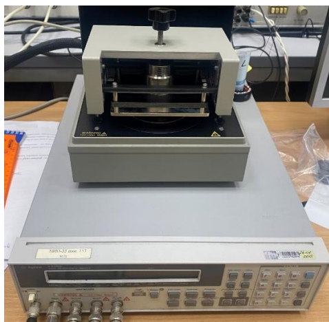
Рисунок 2.17 – Внешний вид прибора Agilent 4339B с лабораторным термостатом
