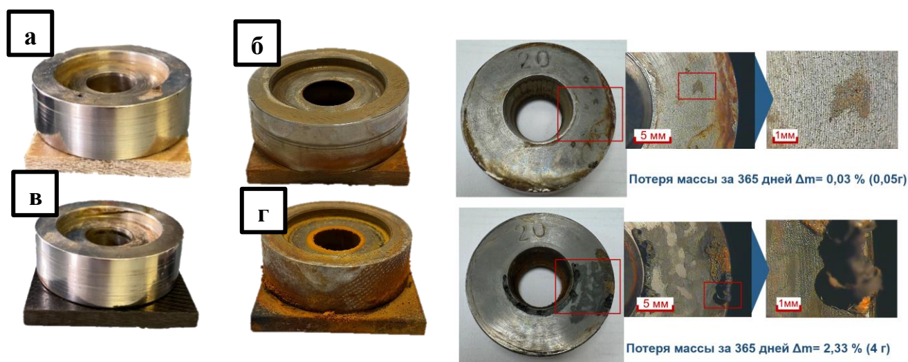
Рисунок 3.22 – Фотографии гальванической пары образец ПКМ – ролик из 20Х13: а) ПЭСТ и ролик до выдержки в воде; б) ПЭСТ и ролик после 90 дней выдержки в воде; в) УГЭТ и ролик до выдержки в воде; г) УГЭТ и ролик после 90 дней выдержки в воде
