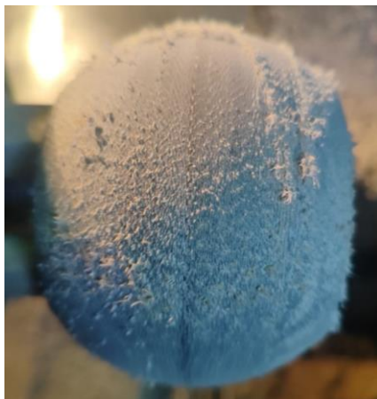
Рисунок 5.7 – Поверхность подшипника при обработке поперек слоев армирования
