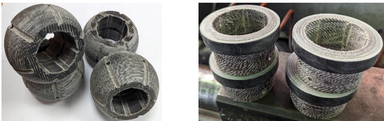
Рисунок 6.6 – подшипников скольжения из гибридного антифрикционного ПКМ марки ПЭСТ-4
