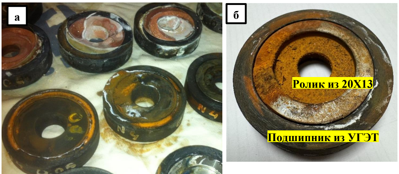
Рисунок 1.1 – Фотография гальванической пары из стальных роликов и подшипников скольжения из антифрикционного ПКМ марки УГЭТ после длительной выдержки в морской воде: а) ролик из 08Х18Н10Т, б) ролик из 20Х13.
