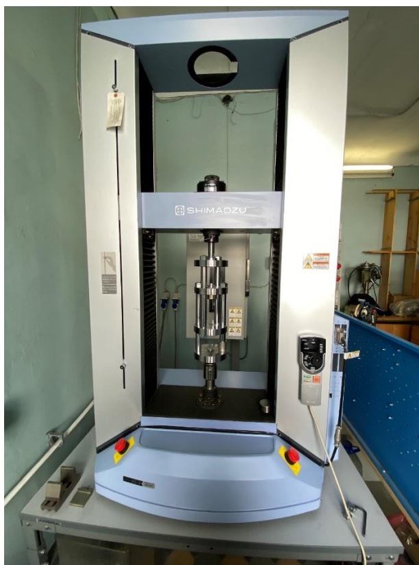
Рисунок 2.14 – Внешний вид испытательной машины Shimadzu AG-50kNX
